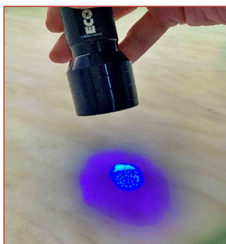
Рис. 4. Подсвечивание метки ультрафиолетовым фонариком.
